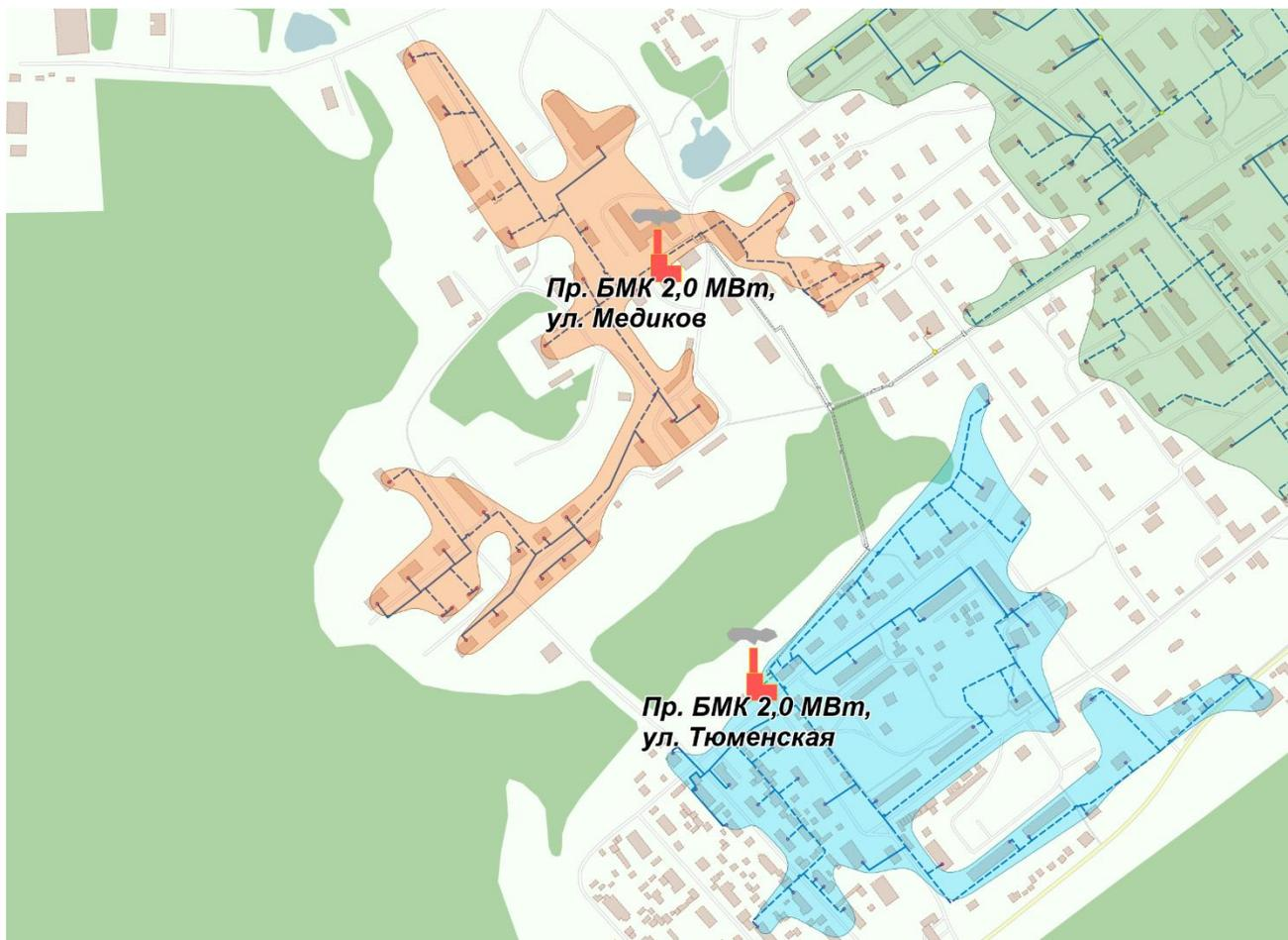
**Рисунок 3. Зоны действия и местоположение новых БМК**
